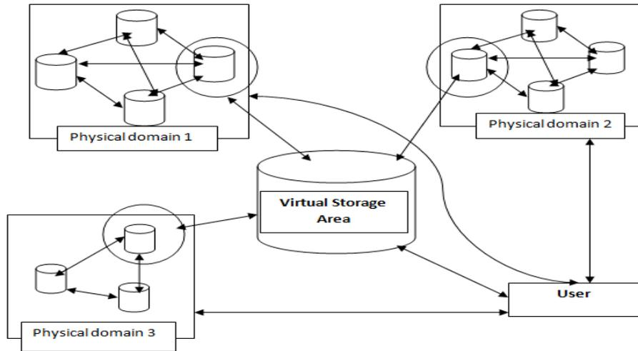
Fig. 2: The DSSM Architecture
